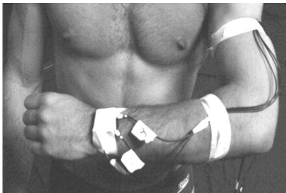
Figura 2. Forma de fixação do acelerómetro no punho
